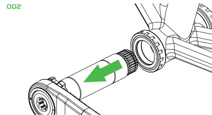
**002** Continuez à tourner le boulon dans le sens inverse des aiguilles d'une montre, il se desserrera et vous sentirez de la résistance lorsque la manivelle commencera à s'extraire de l'axe, continuez à tourner jusqu'à ce que la manivelle côté transmission se détache complètement de l'axe.
